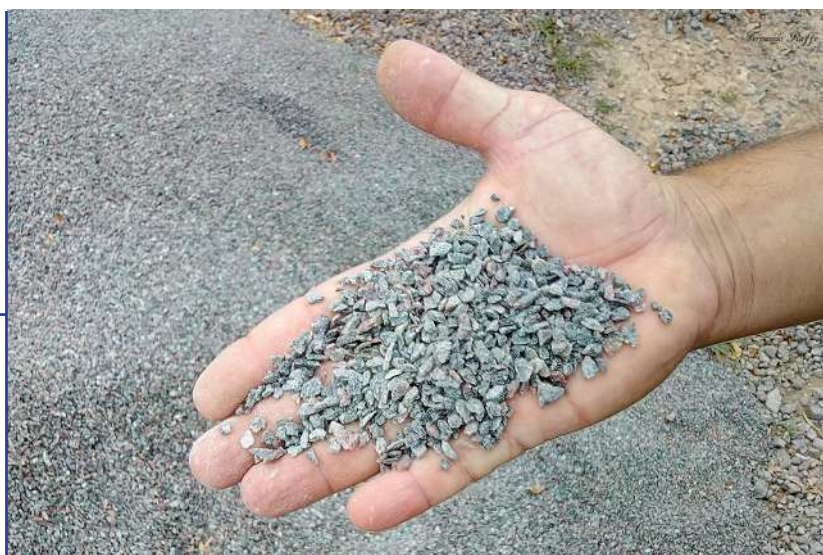
Figuras 31a a 31f. Áridos más utilizados en humedales subsuperficiales.
