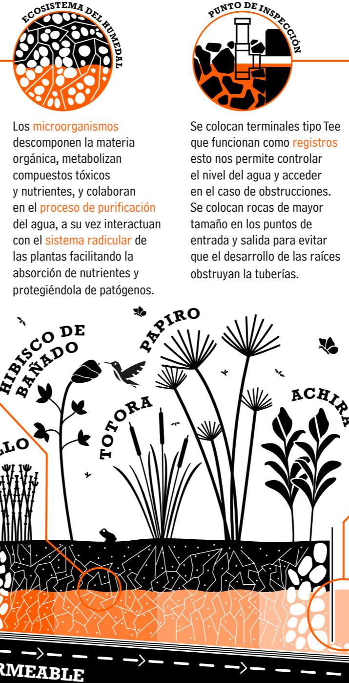
Se colocan terminales tipo Tee que funcionan como **registros** esto nos permite controlar el nivel del agua y acceder en el caso de obstrucciones. Se colocan rocas de mayor tamaño en los puntos de entrada y salida para evitar que el desarrollo de las raíces obstruyan la tubería.
